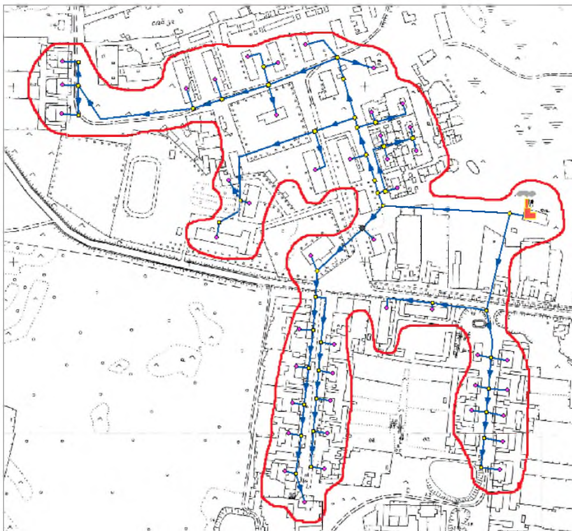
Рисунок 13. Зона действия котельной № 5, с. Захаровское
