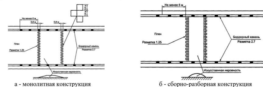
Рисунок 4 - Пример нанесения разметки 1.25 и 2.7 при устройстве ИН
