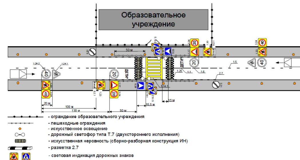
Типовая схема организации дорожного движения на нерегулируемом пешеходном переходе в непосредственной близости от образовательного учреждения при трехполосном движении транспортных средств.
